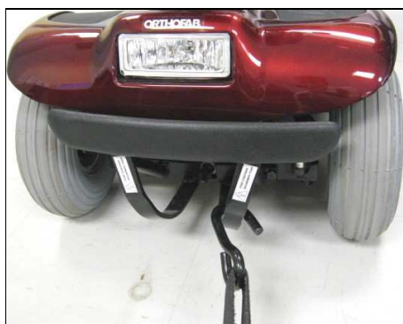
Ancrage à la structure du châssis avant pour le LUNAR 4
