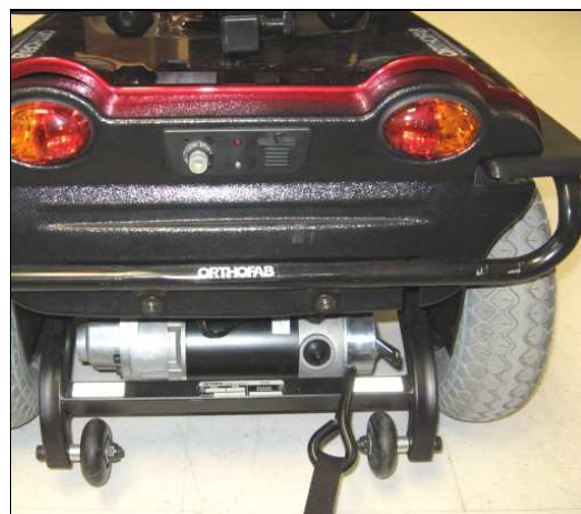
Ancrage à la structure de châssis arrière pour le HYPER 4
