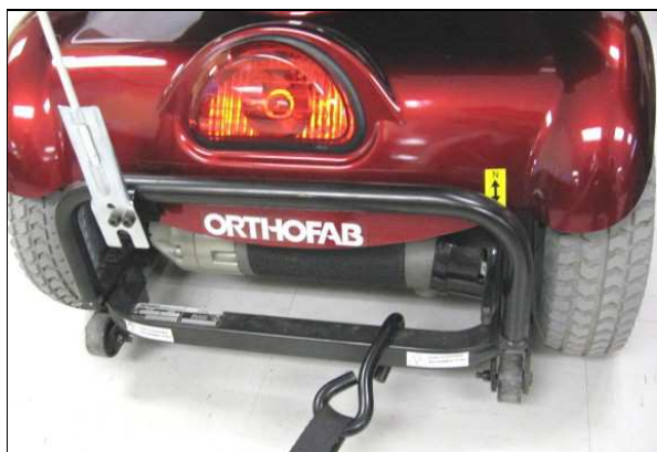
Ancrage à la structure de châssis arrière pour le LUNAR 4, le STAR 4S et ASTRO
