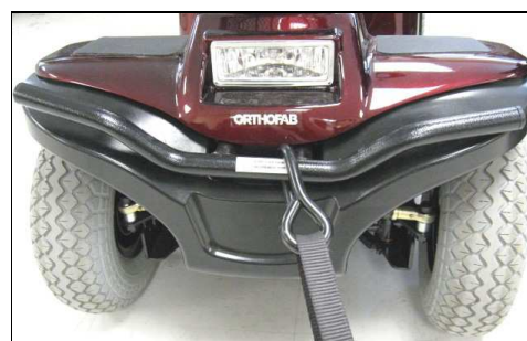
Ancrage au pare-choc avant pour le HYPER 4
