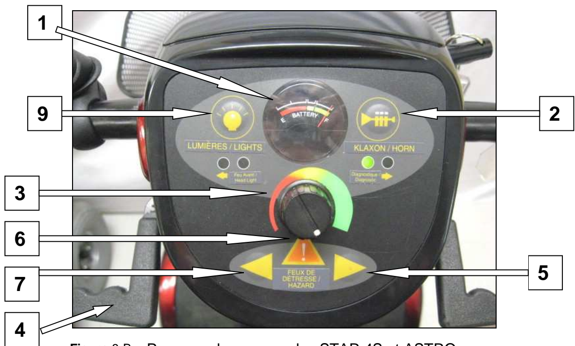
Figure 8-B Panneau de commandes STAR 4S et ASTRO
