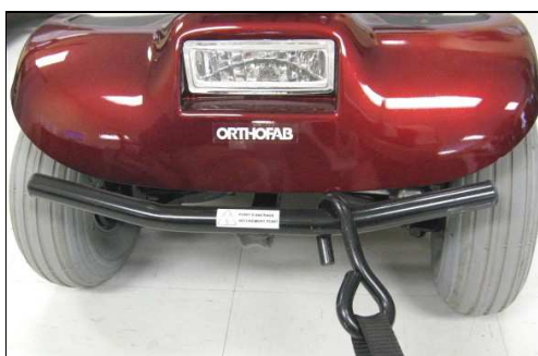
Ancrage au pare-choc avant pour le STAR 4S et ASTRO
