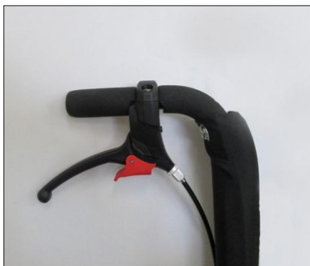
Figure 1: Manette de désengagement des freins.
