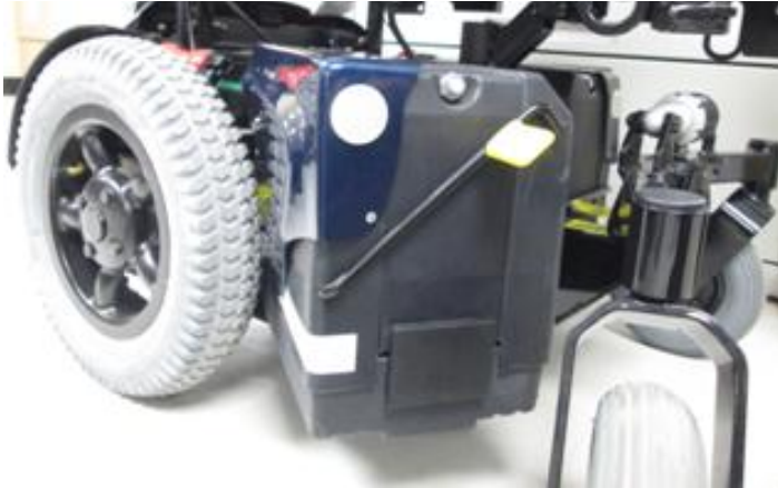
Figure 17 : Remise en place du compartiment à batterie.
