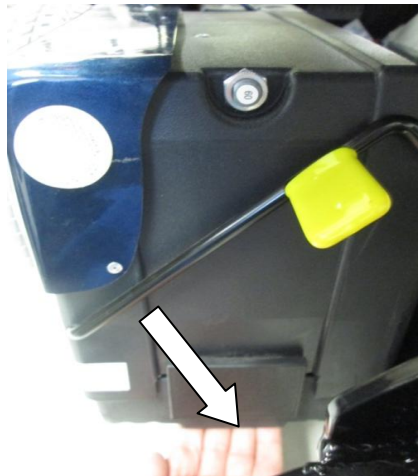
Figure 11: Retirer le compartiment à batterie.
