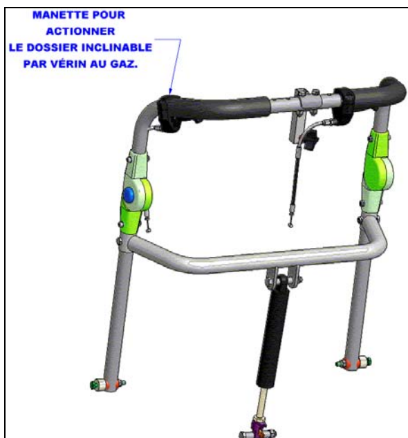
Figure 23 : Poignée du dossier inclinable avec vérin au gaz.
