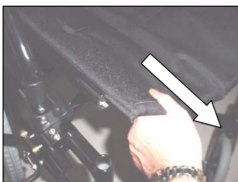
Figure 8-C : Retirer la toile de siège.
