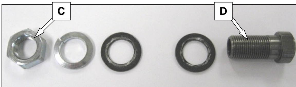
Figure 15-B : Ordre d'assemblage des entretoises de roues arrière.
