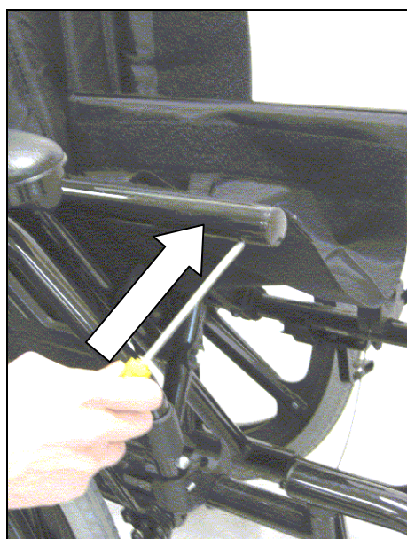
Figure 8-A : Enlever les bouchons de retenus au bout des croisillons.
